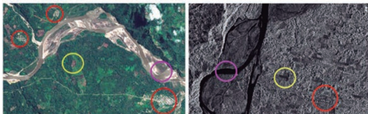
Figura 2: Diferencias entre imágenes de radar vs ópticas. Fuente: diseño propio empleando imágenes de libre uso en internet.
